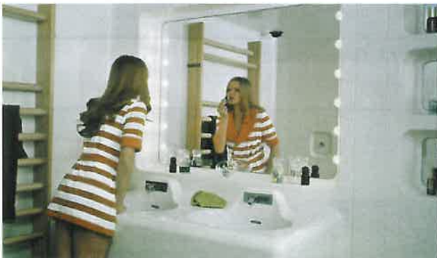
Abb. 11: Sanitärzelle in GF-UP Polyesterschaum-Sandwichbauweise
