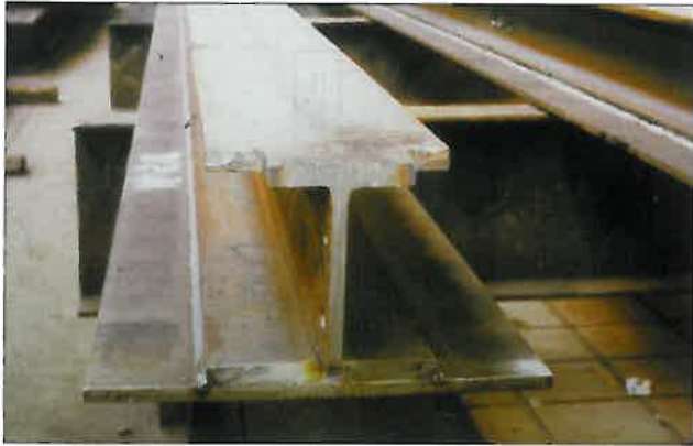
Abb. 10: Typischer Trägerquerschnitt bei Verbundflachträgerdecken mit Teilfertigteilen
