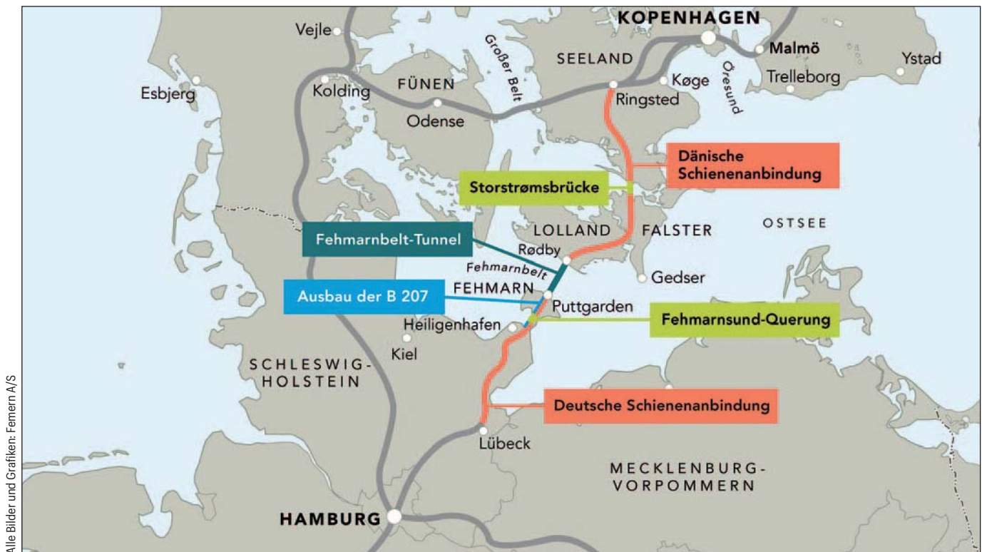
Abb. 1: Fehmarnbelttunnel mit Hinterlandanbindungen
