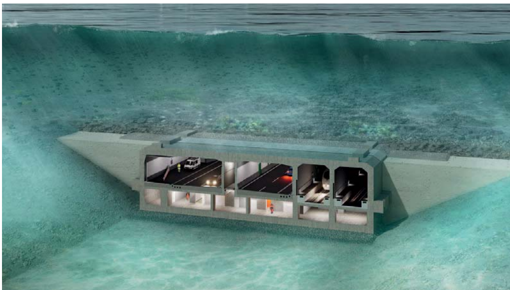
Abb. 6: Die Spezialelemente dienen der Tunnelversorgung und sind über die Tunnellänge gleichmäßig verteilt.
