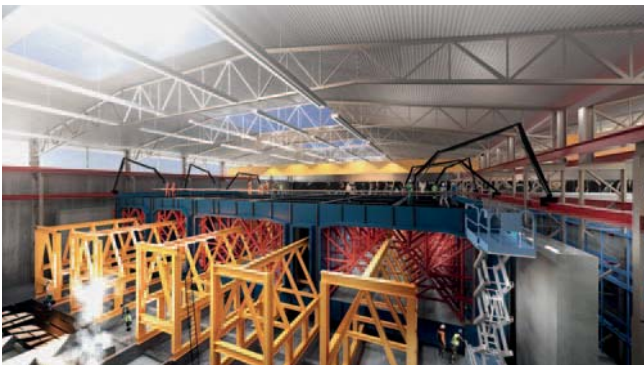
Abb. 8: Animation einer Fertigungslinie der Tunnelfabrik in Lolland
