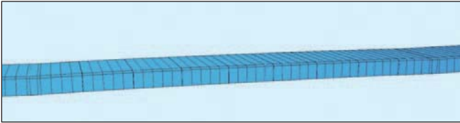
Abb. 20 a: Vollständig überdrückter Tunnelbereich
